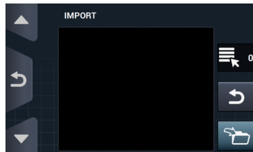
Wird die Funktion IMPORTIEREN ausgewählt, so erscheint derselbe Bildschirm wie auch bei den Programmen, der das Navigieren auf dem USB-Speicher ermöglicht. Allerdings können in diesem Fall ausschließlich Dateien von Preisplänen ausgewählt werden (Erweiterung .plan). Zum Importieren kann nur ein einziger Plan ausgewählt werden.
