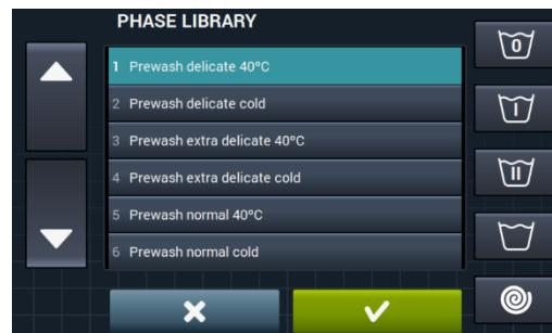
Выбрав цикл из библиотеки, просмотрите его параметры перед включением их в создаваемую программу.
