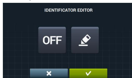
Die Aktivierung des Gerätekennzeichners erfolgt durch Drücken der Taste OFF und anschließendes Betätigen der Bearbeitungstaste .
