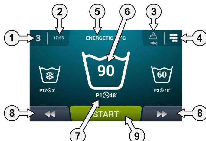
1. **Identificador de máquina:** Etiqueta que identifica la máquina.
