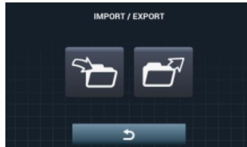
Si IMPORTER est sélectionné, un écran de navigation à travers l'USB sera affiché, seuls les fichiers de configuration (extension .cfg) pourront être sélectionnés.
