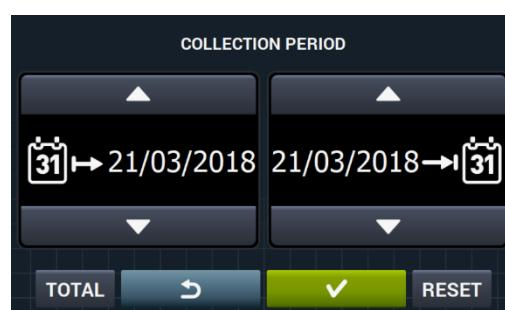
Se si preme su "TOTAL", verranno mostrati i valori complessivi della macchina. Se si inserisce una data, verranno mostrate le statistiche relative esclusivamente a questo periodo. Premendo "Reset", tutti i valori verranno inseriti su 0, e le statistiche azzerate.
