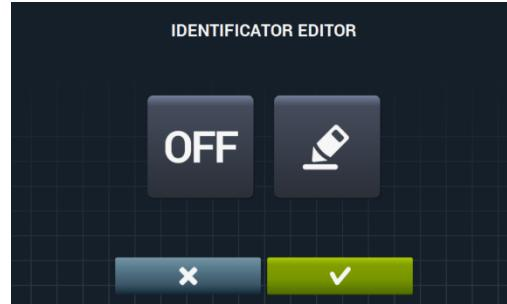
L'identifiant de la machine est activé en appuyant sur le bouton « OFF » **OFF** puis sur le bouton d'édition
