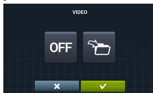
Nach Drücken der Importtaste , kann ein Videofilm von einem externen USB-Speicher in das Gerät importiert werden. Es können ausschließlich Videodateien (mp4) importiert werden und es kann nur eine einzige Videodatei in das Gerät installiert werden. Die werkseitig empfohlene Auflösung beträgt 480x272 Pixel für Geräte mit 4,3-Zoll-Bildschirm und 800x480 Pixel für Geräte mit 7-Zoll-Bildschirm. Der Hersteller rät davon ab, 16 Fps zu überschreiten. Die höchstzulässige Dateigröße beträgt 25 Mb.
