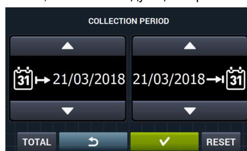
При помощи опции «TOTAL» можно получить общие значения машины. Если ввести дату, то отобразятся данные только за конкретный период времени. При помощи кнопки «Reset» можно сбросить всю статистику до 0.
