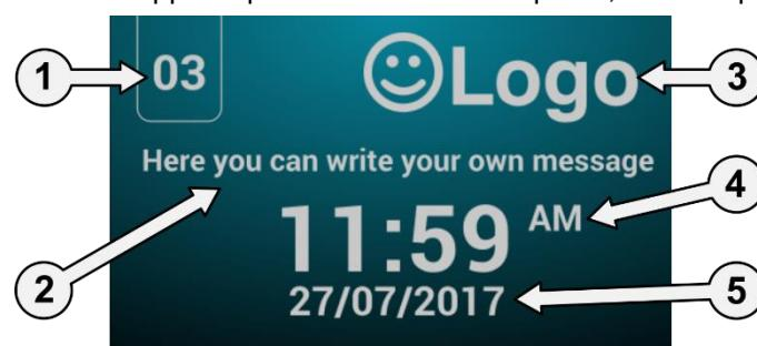
1. **Identificatore della macchina:** Etichetta di identificazione della macchina (se è stato abilitato).
