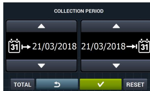
Nach Drücken der Anzeige TOTAL werden die Gesamtwerte des Gerätes angezeigt. Nach Eingabe eines Datums werden ausschließlich die zu diesem Zeitraum gehörenden Statistiken angezeigt. Nach Drücken von „Reset“ werden alle Werte auf Null gesetzt und die Statistiken wieder zurückgesetzt.
