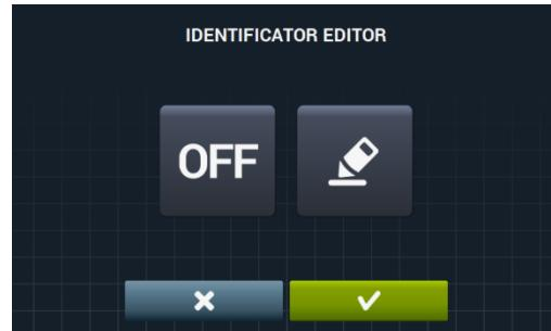
L'identifiant de la machine est activé en appuyant sur le bouton « OFF » puis sur le bouton d'édition .
