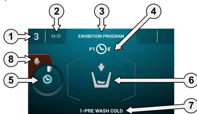
1. **Identificatore della macchina:** etichetta di identificazione della macchina
