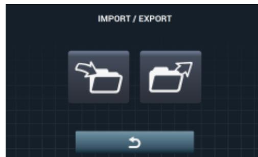
Wird die Funktion IMPORTIEREN ausgewählt, so erscheint der Bildschirm zum Navigieren auf dem USB-Speicher. Allerdings können in diesem Fall ausschließlich Einstellungsdateien ausgewählt werden (Erweiterung \*.cfg).
