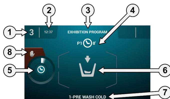
1. **Identificador da máquina:** Etiqueta que identifica a máquina.
