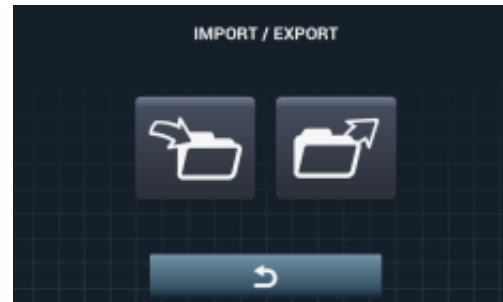
Si seleccionamos IMPORTAR, se nos mostrará pantalla para poder navegar por el USB, solamente se podrán seleccionar ficheros de configuración (extensión .cfg).
