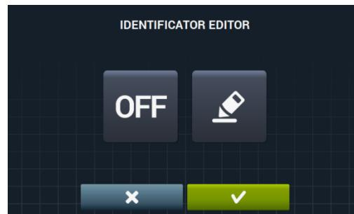
Die Aktivierung des Gerätekennzeichners erfolgt durch Drücken der Taste OFF **OFF** und anschließendes Betätigen der Bearbeitungstaste .
