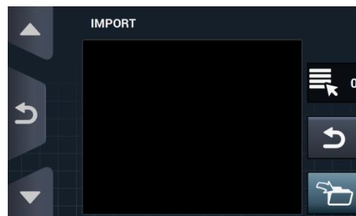
Si l'importation est sélectionnée, le même écran que dans des programmes est affiché pour naviguer à travers le port USB, mais seuls des fichiers de plan (avec extension .plan) peuvent être sélectionnés. Il est seulement possible d'importer un plan lors de l'importation.
