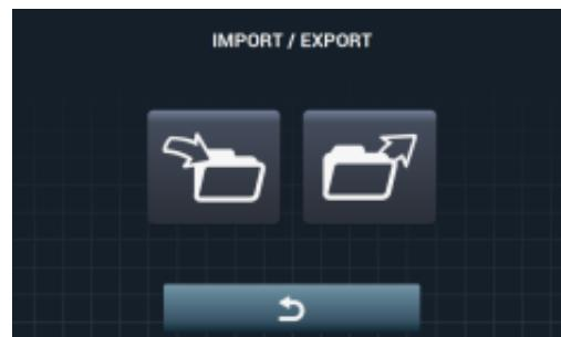
Se viene selezionato IMPORTA, apparirà la schermata per navigare nell'USB, anche se potranno essere selezionati solo i file di configurazione (estensione .cfg).
