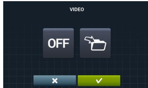
Нажатие на кнопку импорт , позволяет импортировать видео в стиральную машину с памяти внешнего USB-накопителя. В этом случае можно импортировать только видео (в формате mp4), при этом можно иметь только одно видео в стиральной машине. Рекомендуемое разрешение для видео для машин с экраном 4,3" составляет 480x272 пикселей, а для машин с экраном 7" — 800x480. Не рекомендуется превышать кадровую частоту размером 16. Максимальный размер файла не должен превышать 25 Мб.
