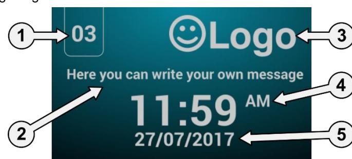
1. **Gerätekennzeichner:** Angabe zur Kennzeichnung des Gerätes (falls die entsprechende Funktion aktiviert ist).
