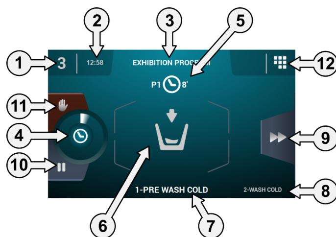
1. **Identificador de máquina:** Etiqueta que identifica la máquina.
