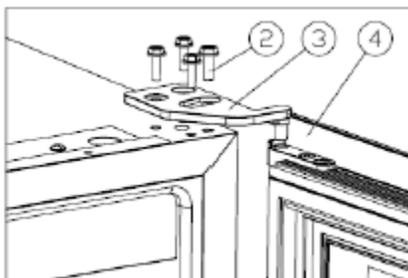
Откройте дверь на 90 градусов и держите ее ровно. Отвинтите винты М5\*16 (2), снимите правую верхнюю петлю (3) и снимите дверь.
