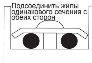
Запрещено зажимать кабели электропитания с жилами одинакового сечения с одной и той же стороны клеммы, также запрещено использовать два кабеля электропитания с жилами разного сечения на одной и той же клемме. В противном случае это может привести к ослаблению соединения из-за неравномерного обжатия, что приведет к аварийным ситуациям.
