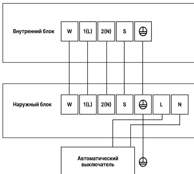
7. Проверьте надежность всех соединений, затем зафиксируйте межблочный кабель кабельным зажимом. Надежно закрепите кабельный зажим винтами. Заизолируйте оставшиеся провода, если такие имеются.
