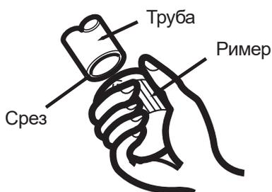
5. Установите комплектные гайки на трубки, с которых уже удалены заусенцы. Гайки должны быть расположены в правильном направлении. **После развальцовки труб установить гайки уже нельзя!**
