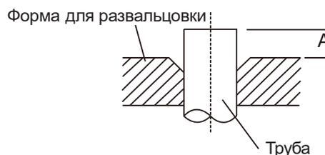
7. Развальцуйте трубу с помощью вальцовок. Снимите вальцовку и форму для вальцовки, осмотрите кромку трубы на предмет трещин и равномерной вальцовки.
