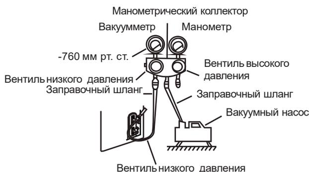
7. Закройте вентиль низкого давления на манометрическом коллекторе. Выключите вакуумный насос. Подождите 5 минут и убедитесь в том, что давление в системе не меняется.
