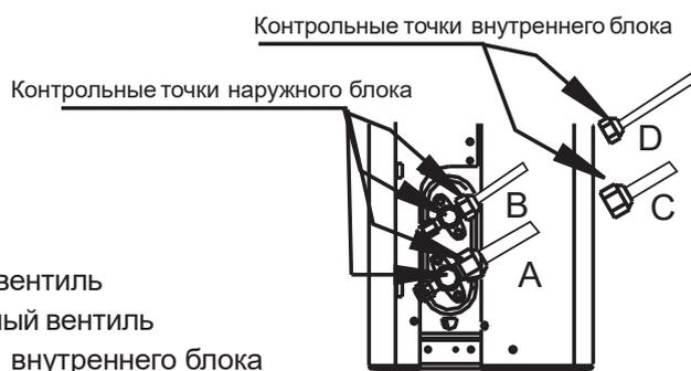
После проверки на предмет утечек плотно изолируйте место соединения штуцеров внутреннего блока с трубами хладагента теплоизолирующей лентой.
