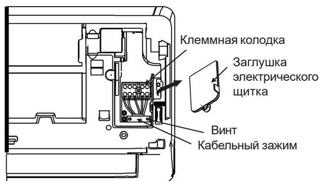
4. Отверните кабельный зажим, расположенный внизу клеммной колодки, и отложите его в сторону.
