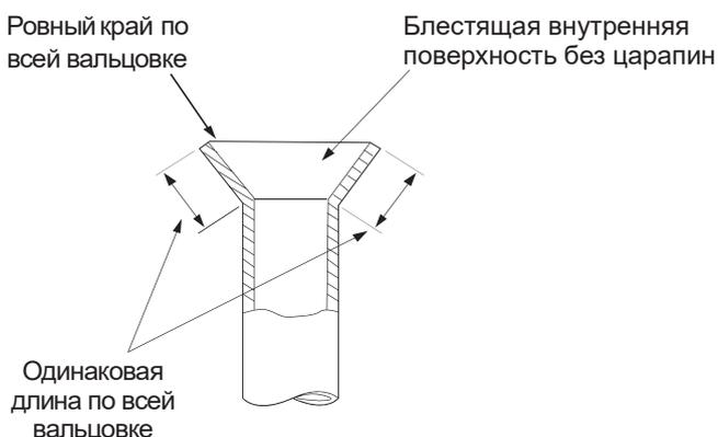
8. Установите развальцованные трубы соосно со штуцером. При подсоединении сначала выровняйте центр, затем затяните конусную гайку на первые 3–4 оборота.
