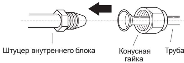
9. Используя динамометрический ключ, затяните конусную гайку. При затяжке ориентируйтесь на значения, приведенные ниже в таблице. Чрезмерная затяжка может повредить развальцованный участок!
