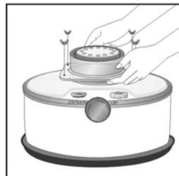
4. Снимите регулировочную ручку со шкива, открутите накидную гайку шкива регулировки высоты фитиля и вытащите шкив с шестерней, потянув его на себя.
