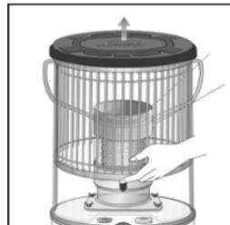
3. Снимите крышку основания фитиля, открутив 4 гайки-барашка.
