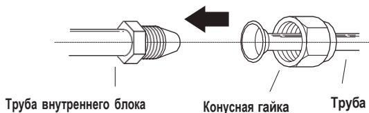
2. Затяните конусную гайку вручную до упора.
