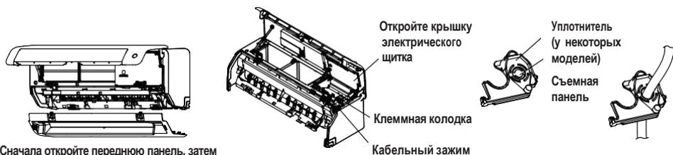
Сначала откройте переднюю панель, затем снимите нижнюю панель.
