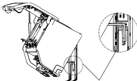
С помощью держателя, расположенного с задней стороны блока, подприте блок к монтажной пластине.
