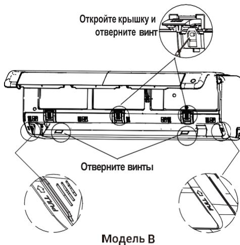
2. С помощью держателя, расположенного с задней стороны блока, подприте блок, чтобы обеспечить достаточно места для присоединения трубопровода хладагента, сигнального кабеля и дренажного шланга.
