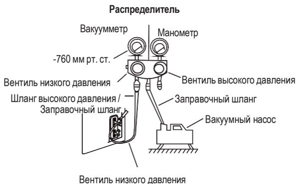
6. Закройте вентиль низкого давления распределителя и выключите вакуумный насос.
