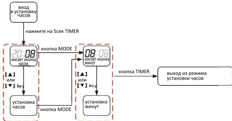
После установок часов нажмите TIMER для сохранения сделанных установок. После установок часов нажмите ON/FF или MODE для выхода без сохранения. Если не нажимать никакие кнопки в течении 15сек, пульт выходит из режима установки часов.
