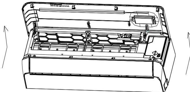
2. Снимите колпачок с USB Wi-Fi-модуля. Вставьте модуль по направлению указательной стрелки в зарезервированный USB-порт блока.
