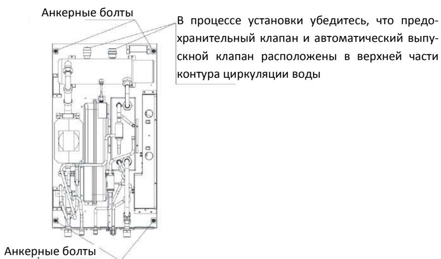
Шаг 4: Установите панель гидромодуля и затяните винты. Подключите сигнальный кабель проводного пульта и установите проводной пульт на панель гидромодуля.
