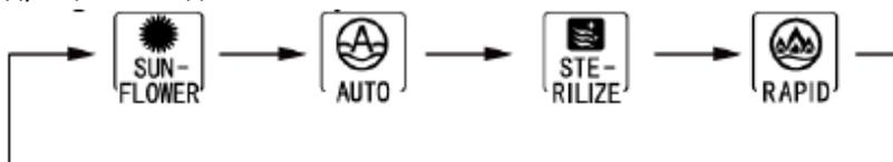
В программируемом или ночном режиме нагрева воды при каждом нажатии кнопки FUNCTION переключение между функциями будет происходить в следующей последовательности:
