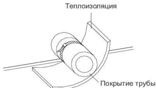
**Установка дренажной трубы для внутренних блоков кассетного типа:**
